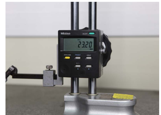
▶ 계측기명: DIGIT HEIGHT GAUGE 규 격: 0~300mm 제 조 처: MITUTOYO
