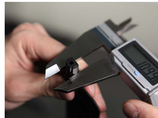
▶ 계측기명: DIGIT V/CALIPERS 규 격: 0~150mm, 200mm, 300mm 제 조 처: MITUTOYO
