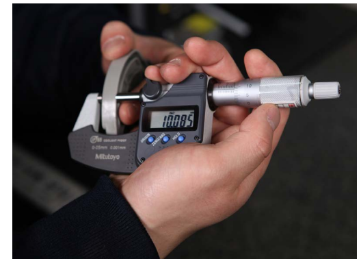
▶ 계측기명: DIGIT MICROMETER 규 격: 0~30mm(단위 0.0001) 제 조 처: MITUTOYO
